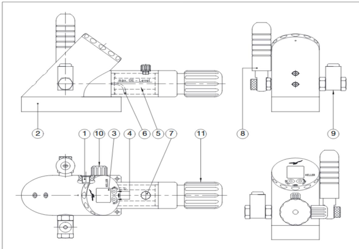
Paso N° 1.) Purgar el Calibrador -> aflojar Nr 7 y 10 / y girar nr 11 hasta el final (direccion agujas del reloj – cerrar hasta final)
